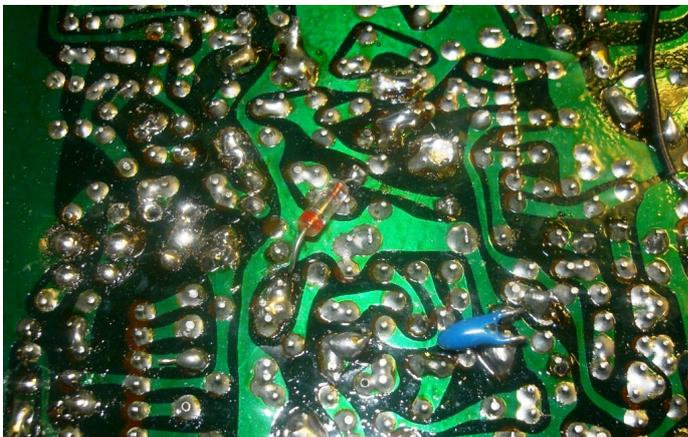
Bild9: Diode D5 neu eingelötet
