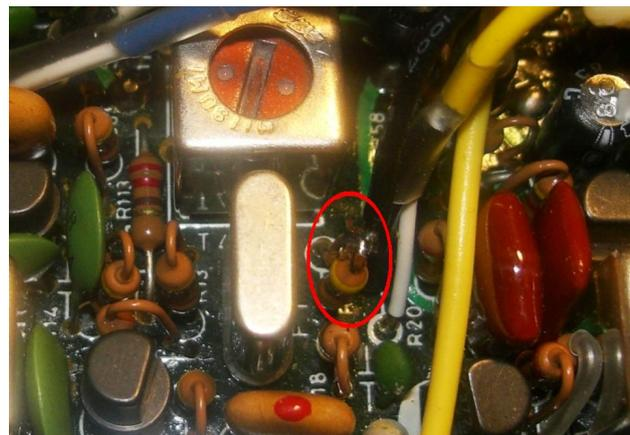
Bild3:Anschluß des ZF-Teils
