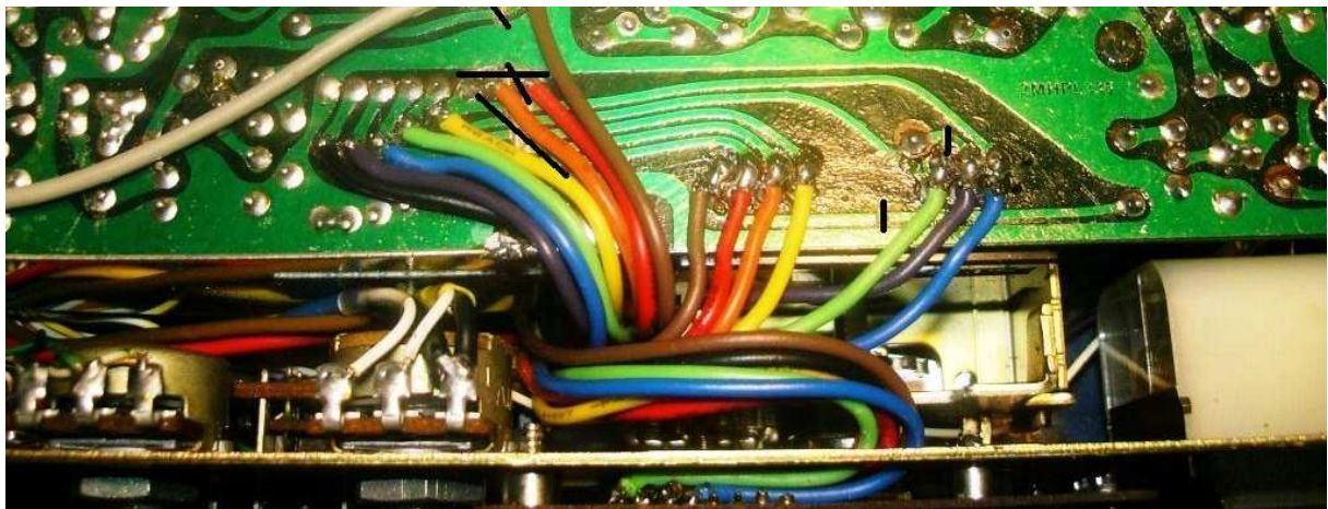
Bild 2: PLL-Umbau am Beispiel CBH2000
